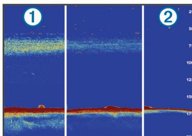
Растяжение эхосигнала и ширину фильтра можно использовать вместе для получения предпочтительного разрешения и уменьшения шумов. При установке низкого значения для растяжения эхосигнала и ширины фильтра
