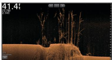
В обычных датчиках используются конусообразные лучи. Для сканирующего сонара Garmin ClearVu предусмотрено использование двух узких лучей, схожих по форме с лучом копировального аппарата. Эти лучи обеспечивают более четкое, напоминающее фотографию изображение пространства под судном.
