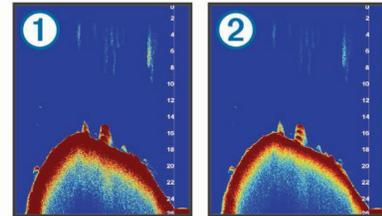
**TVG:** Настройка внешнего вида отраженных сигналов для компенсации ослабления сигналов на большой глубине и снижения поверхностного шума. При увеличении параметра данной настройки цвета, соответствующие шуму низкого уровня и значкам рыбы, будут выглядеть более плотными на разной глубине. Эта настройка также помогает снизить шум около поверхности воды.
