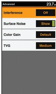
**Interference (наводки):** Обеспечивает настройку чувствительности для снижения влияния наводок от ближайших источников шума.
