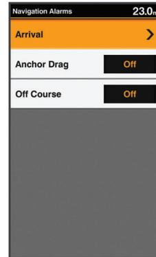
**Anchor Drag (дрейф от места якорной стоянки):** Устройство выдает предупреждение, когда вы превышаете указанное расстояние дрейфа во время якорной стоянки.
